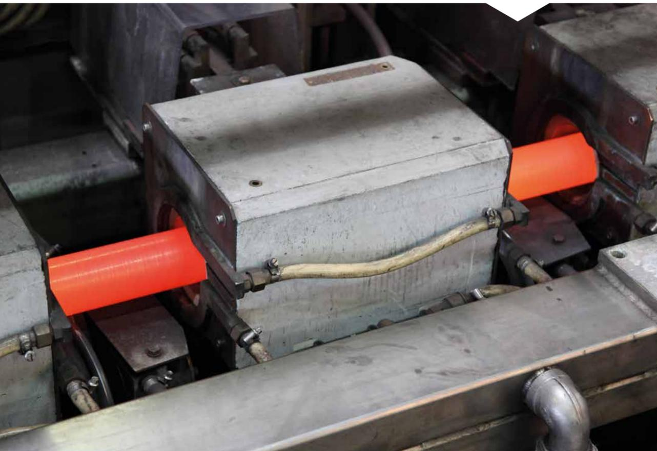
*Die Abmessung der Spulen zur induktiven Erwärmung stimmt Steeltec auf den Durchmesser des Stabstahls ab, um den größtmöglichen Wirkungsgrad bei der Erwärmung zu erzielen.*
