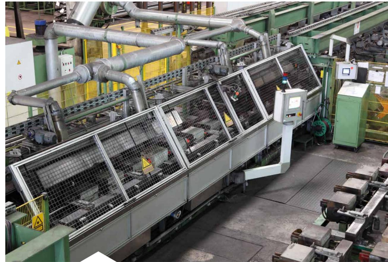
*Bei der Einzelstabvergütung durchläuft jeder Stab die Wärmebehandlung einzeln, damit ein gleichmäßiges qualitatives Niveau der mechanisch-technologischen Stahleigenschaften über den ganzen Stab erzielt wird.*
